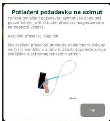
Obrázek č. 2: Informační hláška kalibrace magnetometru.
