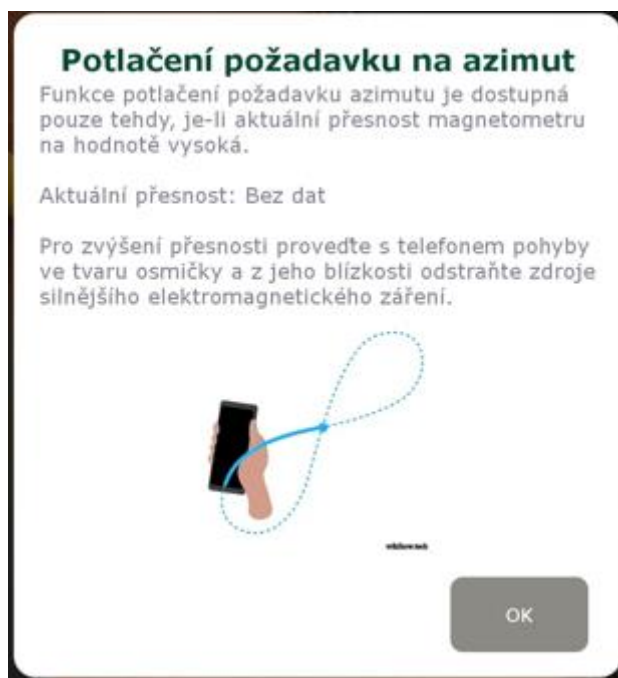
Obrázek č. 58: Kalibrace kompasu a gyroskopu.
